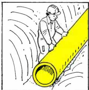
Freigelegte Gasleitungen sind vor dem Eindecken durch die zuständige Gasversorgung mittels einer Sichtprüfung auf Beschädigungen zu kontrollieren.
